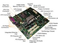
Motherboard berfungsi untuk menghubungkan komunikasi antara CPU, RAM dan semua komponen perangkat keras komputer.
